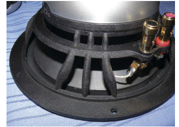
Необычная геометрия корзины — результат вибрационного анализа
