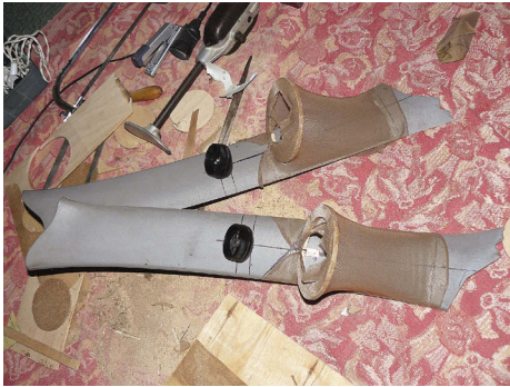
Фиксация углового положения СЧ и ВЧ-излучателей
